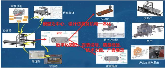
(图 8: MBD 模型数据贯穿整个产品开发流程)
